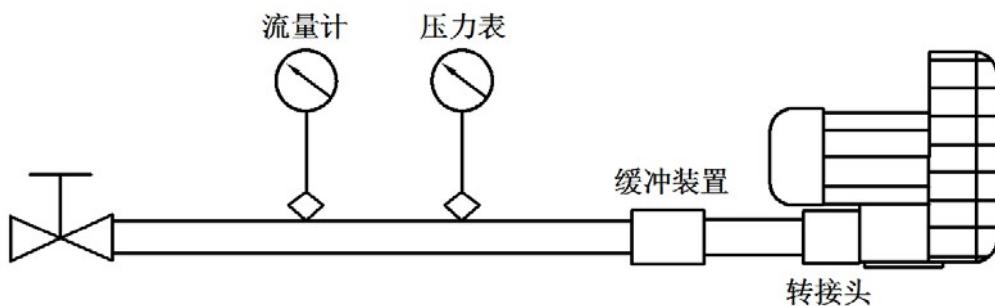
图A. 1 气泵性能实验的连接示意图
